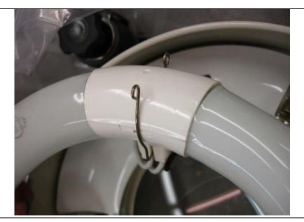
INSTALL RETAINING SPRING AS SHOWN HERE
