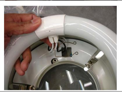
INSERT RETAINING SPRING BETWEEN WIRES
